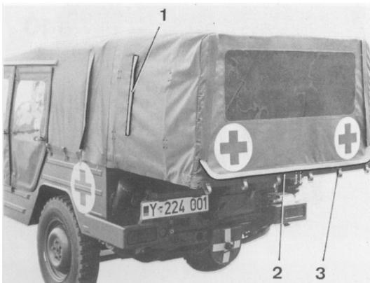
Bild 21 Zusatzverdeck mit Reißverschlüssen
