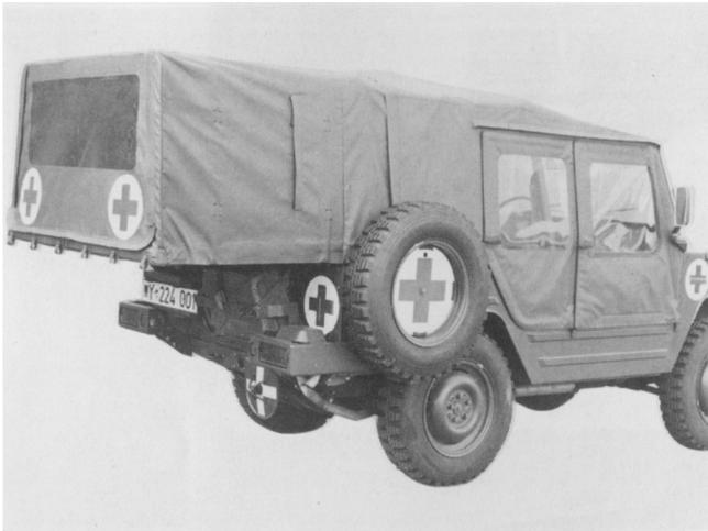
Bild 8 Reserverad rechts außen an der Ladefläche angebaut
