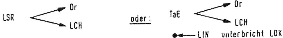
Eine Kombination der beiden Verkehrsformen LIN und LOK stellt die Verkehrsform LIN/LOK dar. Neben dem Schreibblocherbetrieb ist gleichzeitiges Senden vom Leser möglich. Durch die Taste MIT kann LSN der Drucker wahlweise der Linie oder dem Lokalkreis zugeordnet werden.
